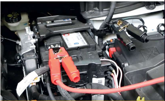
Akü Şarj Battery Charging
